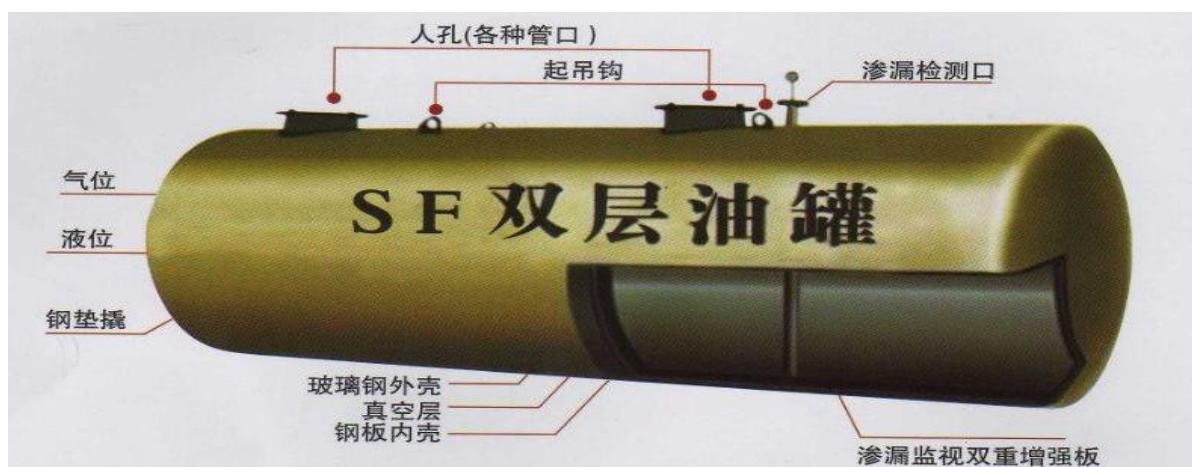
图2-1 SF双层储油罐结构示意图
